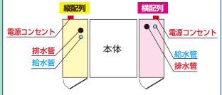
●給水バルブはユーザーが容易に操作できる 位置・向きに取り付けてください。
